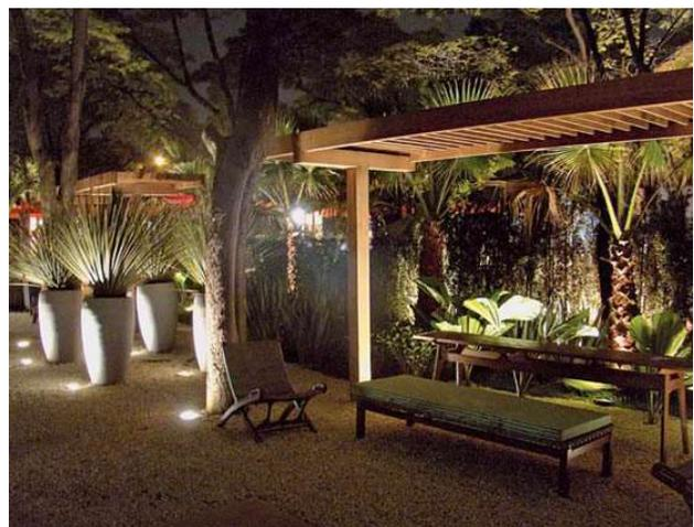
**Figura 25 - Utilização de lâmpada halógena halopar 20 embutida no chão**
